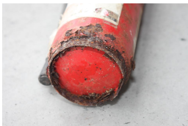
溶接部及びその周辺の剥離
