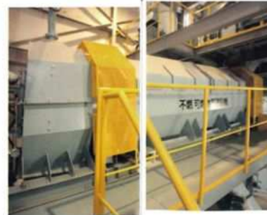
■不燃可燃等選別機 破砕ゴミを穴の大きさの回転式ふるいによって不燃物・可燃物に分別します。
