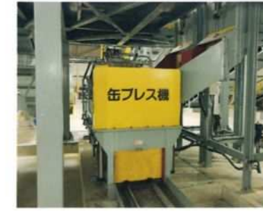
■缶プレス機 回収されたスチール缶やアルミ缶を圧縮します。
