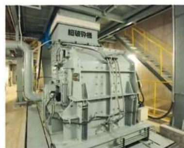
■細破砕機 高速回転する二次破砕機でたたくことで、ゴミをさらに細かくします。
