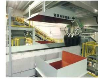
■手選別作業 手作業により異物や処理不適物を取り除きます。
