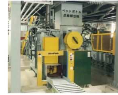
■ペットボトル圧縮梱包機 回収されたペットボトルを圧縮し梱包します。
