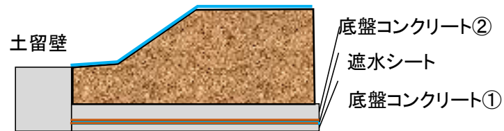
底盤コンクリート詳細図
