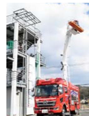
▲13mブーム付多目的消防ポンプ自動車
