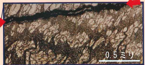
断面の拡大。孔は道管（水の通る孔） 茶色の部分は繊維細胞、矢印は年輪
