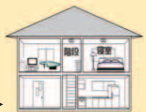
住警器設置場所例→
