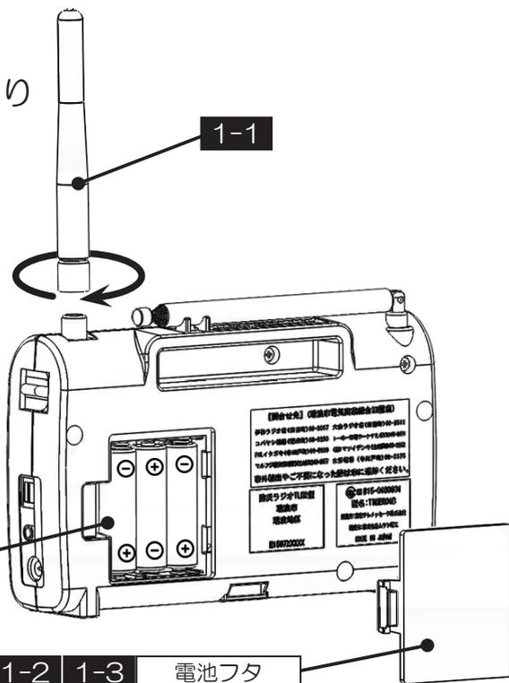
**❗注意** 電池LED(赤)が3秒に1度の間隔で点滅したときは、電池が消耗しています。新しい電池に交換してください。電池は1年程度が交換の目安になります。電池が消耗していなくても、定期的に交換をお願いします。
