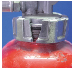
× キャップの破損
