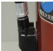
× 消火薬剤の漏れ
