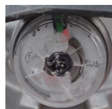
× 指示圧力計の損傷
