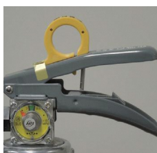
× レバー支えの脱落
